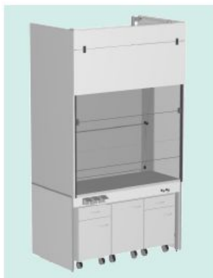
MODÈLE SMP 150 DIMENSIONS 1540/820/2700 mm DÉBIT 1100m 3 /H pour 25 mm 3 /ce REJET D'EXTRACTION DN 250 mm
