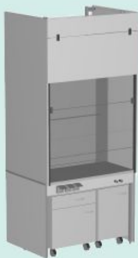
MODÈLE SMP 120 DIMENSIONS 1240/820/2700 mm DÉBIT 900m 3 /H pour 20 mm 3 /ce REJET D'EXTRACTION DN 200 mm
